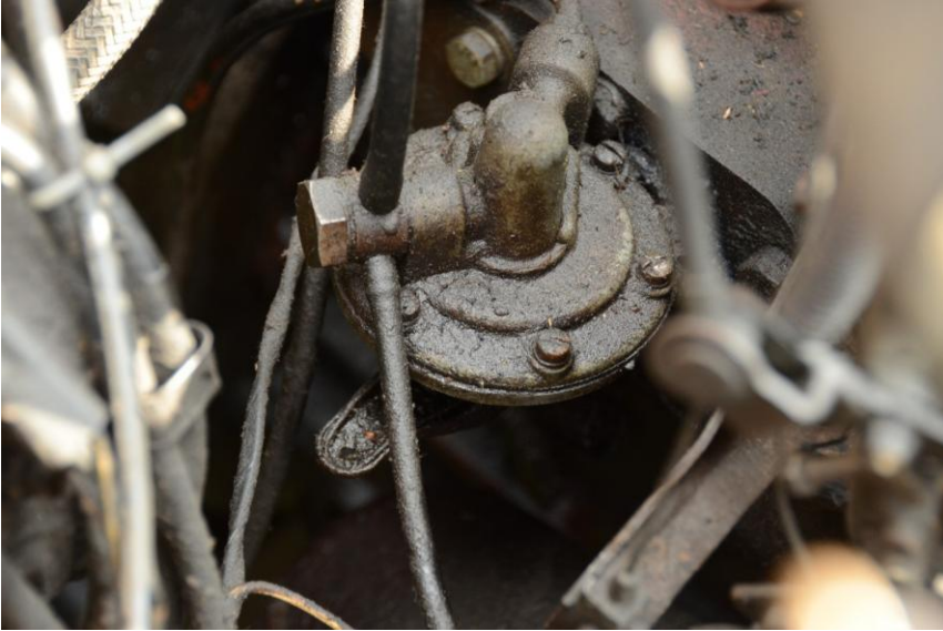
Billede 29: Håndpumpe til at udlufte diesel.
