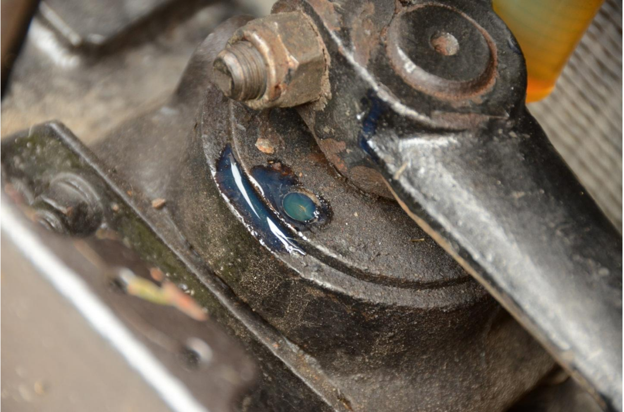
Billede 12: Fyld olie indtil det løber lidt over. Engangssprøjte ses i baggrunden hvor den sidder i det andet bolt hul.
