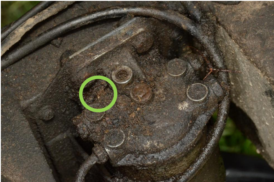
Billede 13: Vand/slam udskiller set for oven (efter at bundpladen er fjernet.)
