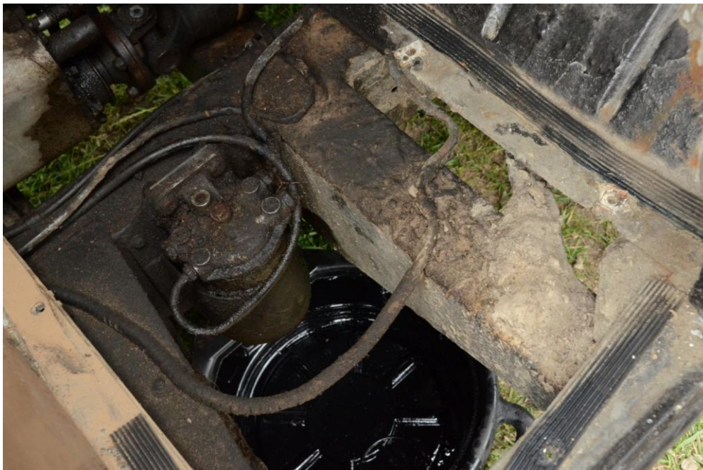
Billede 14: Oliebalje under da der vil dryppe/løbe Diesel ud mens filteret er adskilt.
