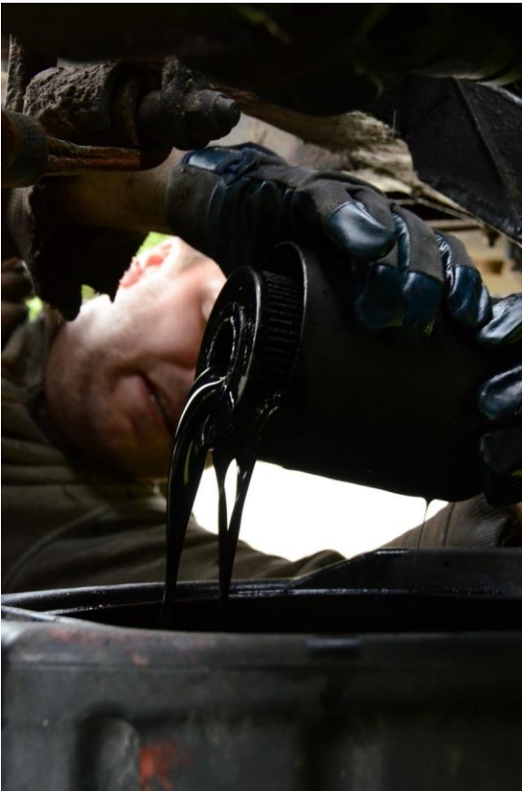
Billede 39: Olie filteret er løs, bare ned i baljen med det for det sviner en del, hæld det ud af filter hylsteret.
