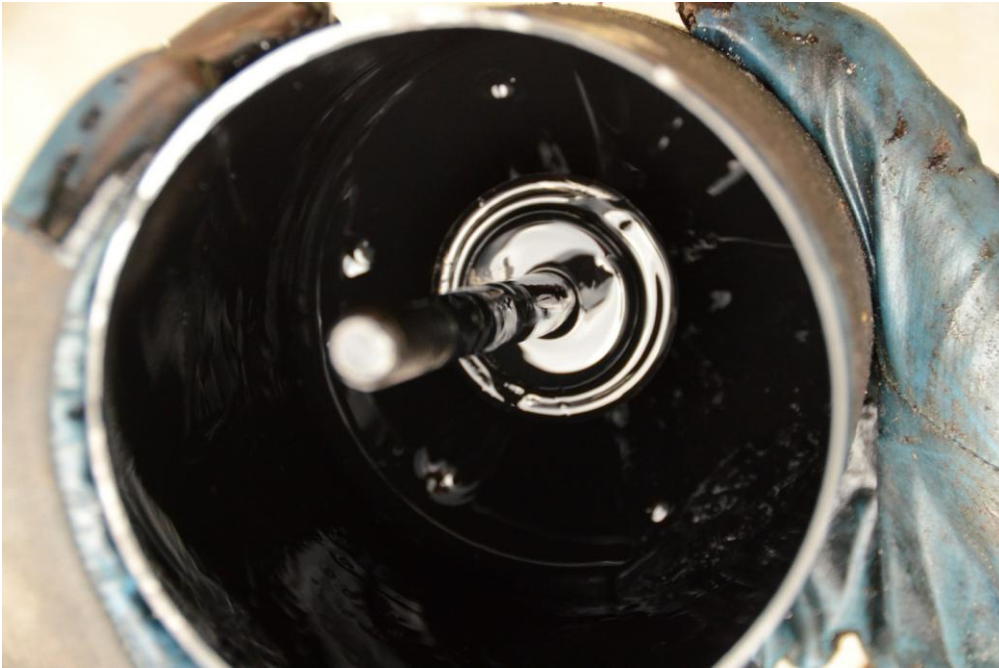
Billede 40: Olie Filter Hylster, med bund plade/dimmer og fjeder.
