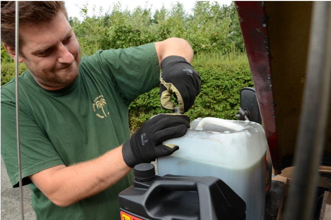
Billede 10: Engangssprøjte fyldes med Gearolie.
