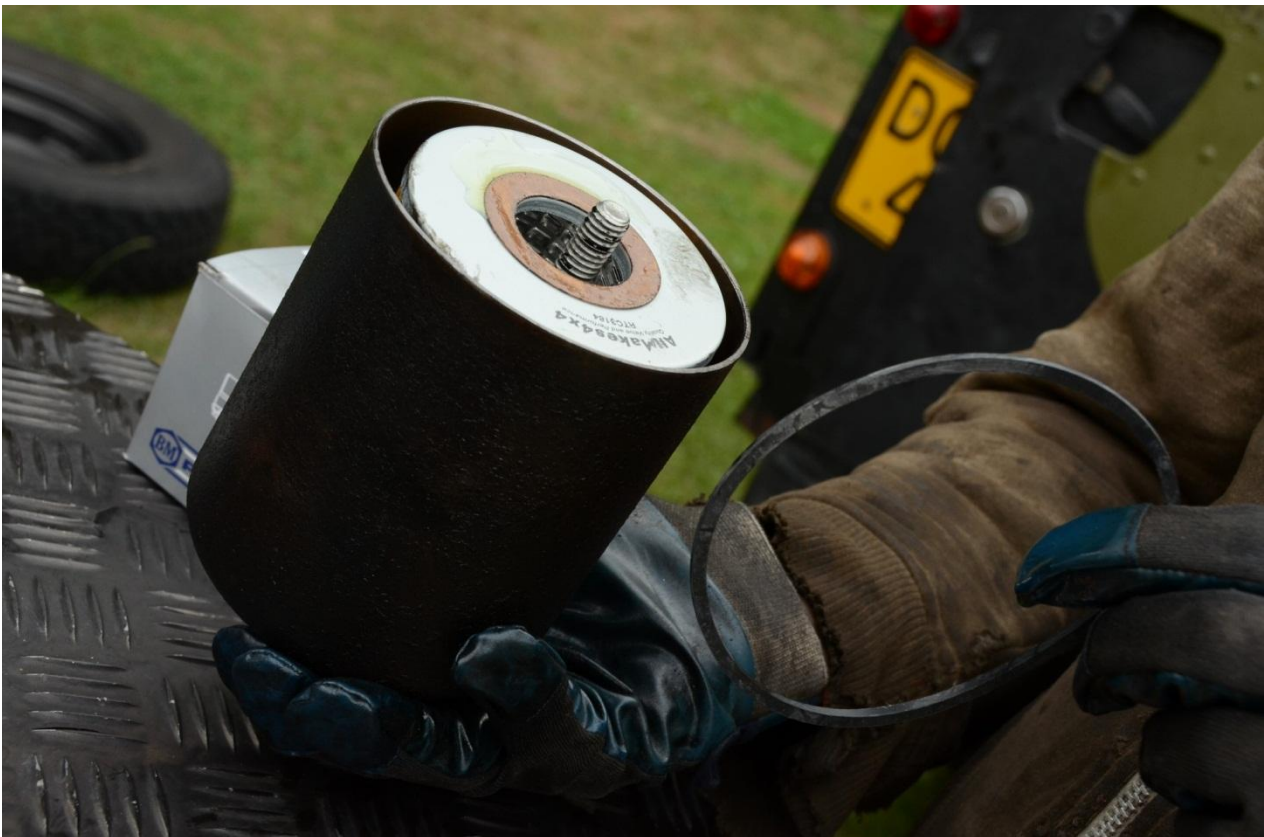
Billede 41: filter hylster med nyt filter i, og O-ring fra toppen.
