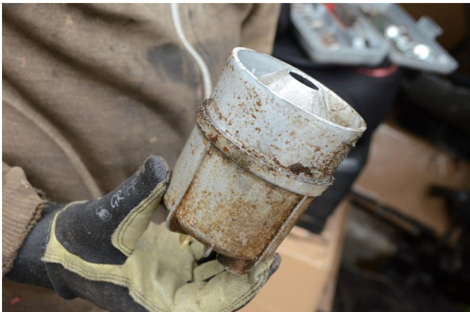
Billede 17: Vand/slam udskiller samlet før montering.
