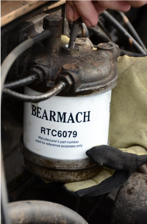
Billede 27: Bund og Filter monteres igen..
