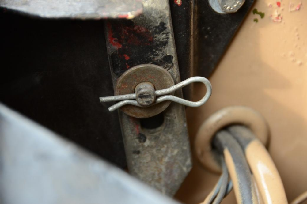
Billede 19: Split til at holde armen til motorhjelm (hurtig at afmontere og montere)
