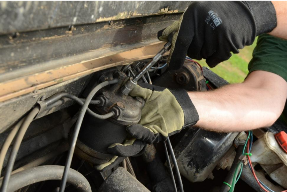
Billede 21: Bolt løsnes så diesel filter kan tages af.
