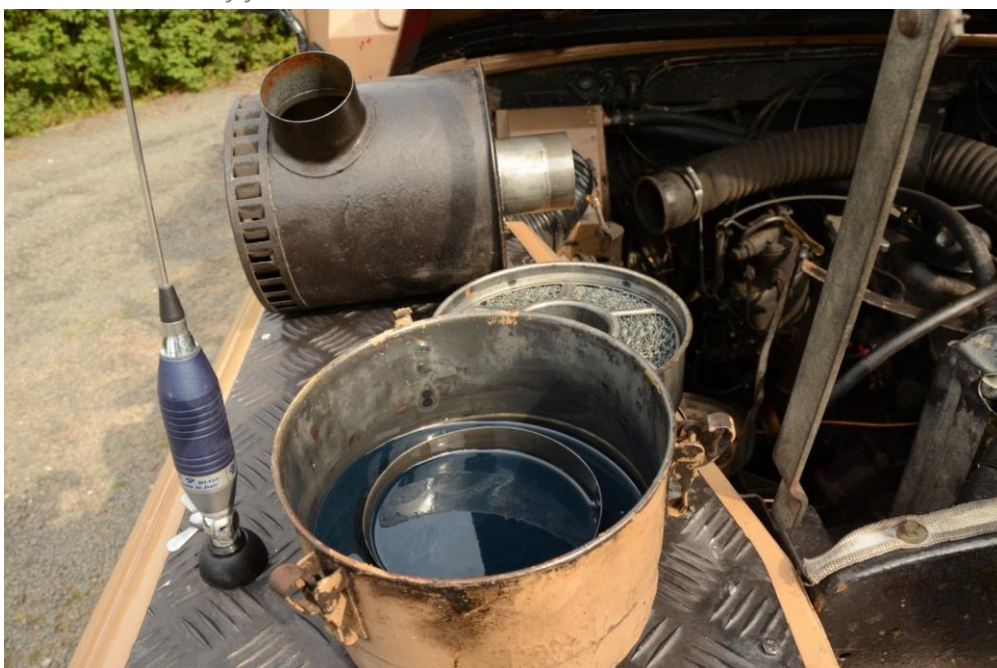
Billede 9: Luftfilteret adskilt.
