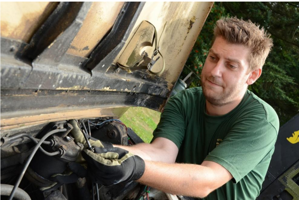
Billede 22: Hold ved filteret inden boltet slipper, så man ikke spilder alt dieselen ud over det hele.
