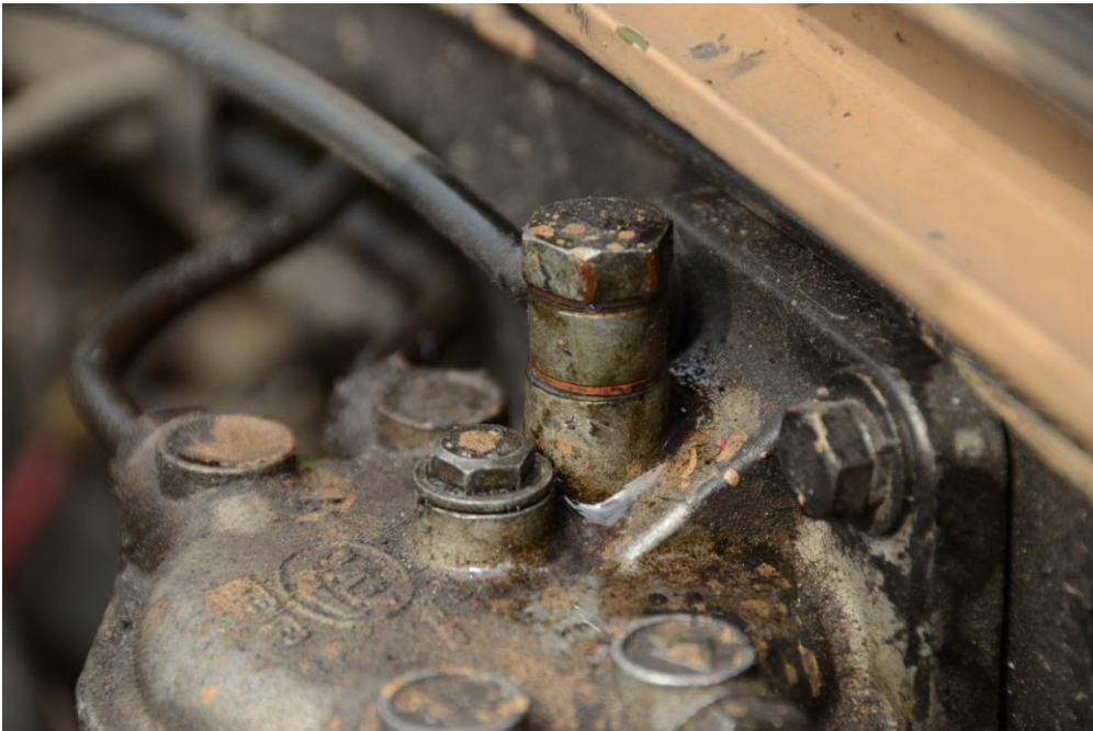
Billede 32: Når der kommer diesel ud ved banjo bolten strammer man den til og stopper med at pumpe.
