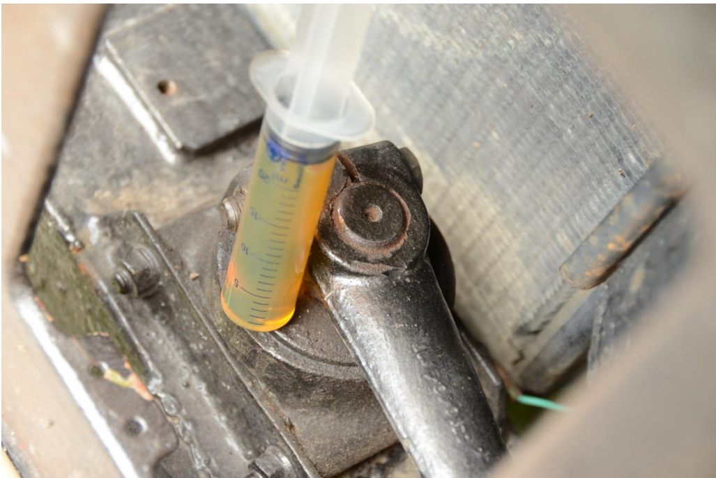
Billede 11: Engangssprøjte isættes der hvor bolten er skruet ud og olien fyldes i.
