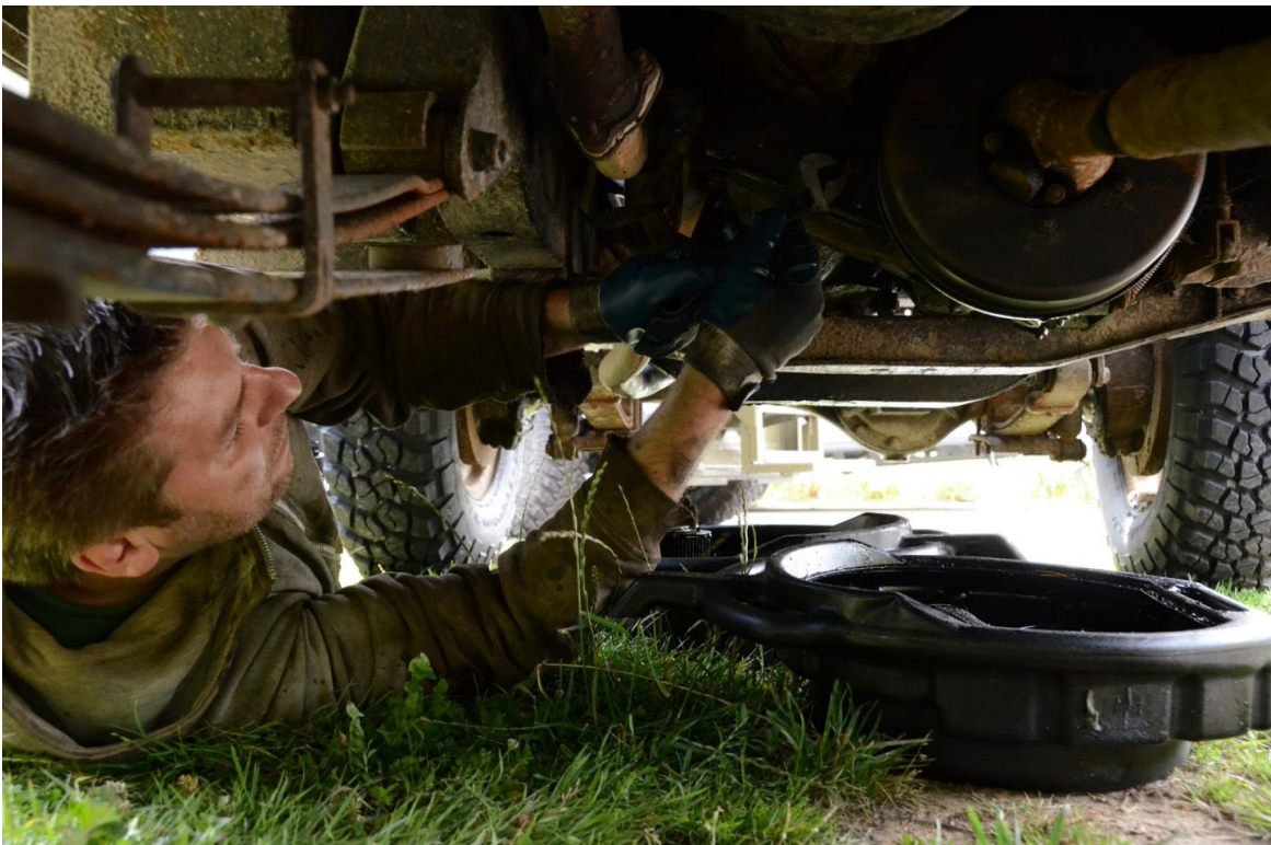
Billede 52: Påfyldnings skrue til gearkassen, sidder på siden af selve gearkassen og kan være lidt svær at komme til.
