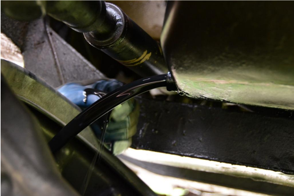
Billede 3: Olien løber ud, man kan eventuelt starte med at løfte olie baljen lidt op så man fanger olien som kan sprøjte lidt ud.
