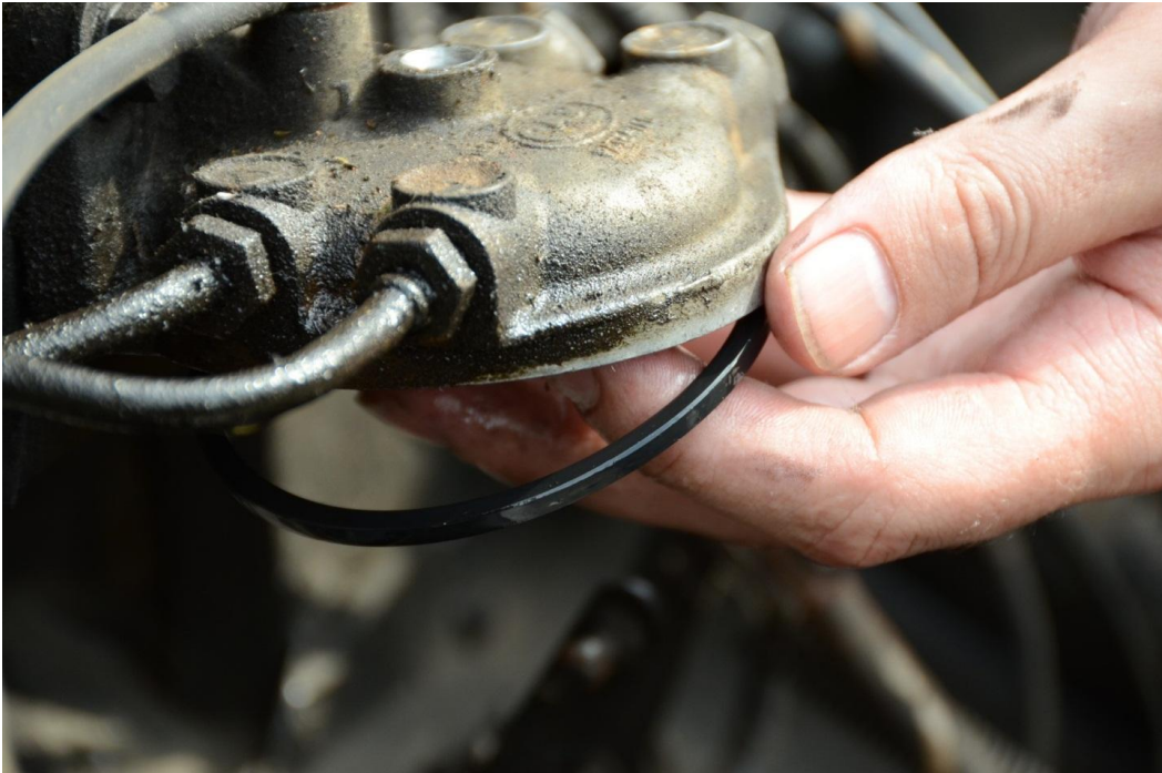
Billede 25: O-ringen gemmer sig i toppen, som sidder fast på torpedoen. O-ringen fås sammen med et nyt filter.
