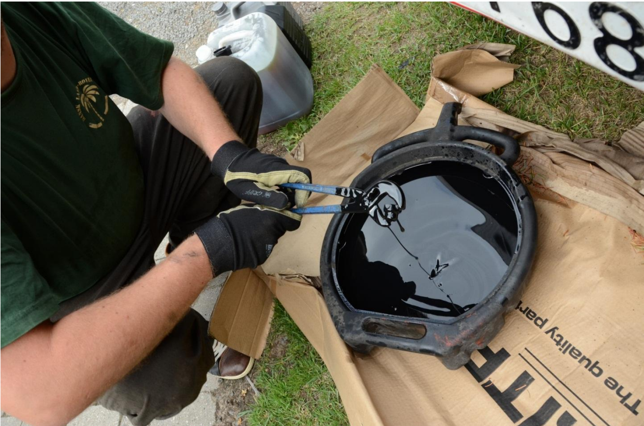
Billede 5: Bundprop fiskes op af oliebaljen.
