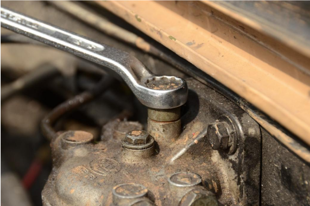
Billede 31: Banjobolten på Brændstof filteret, den skal løsnes FØR man pumper...
