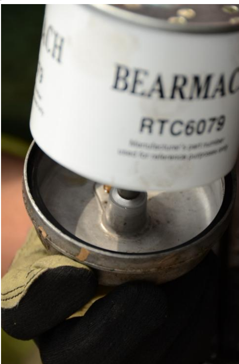
Billede 26 Bunden sættes på filteret.
