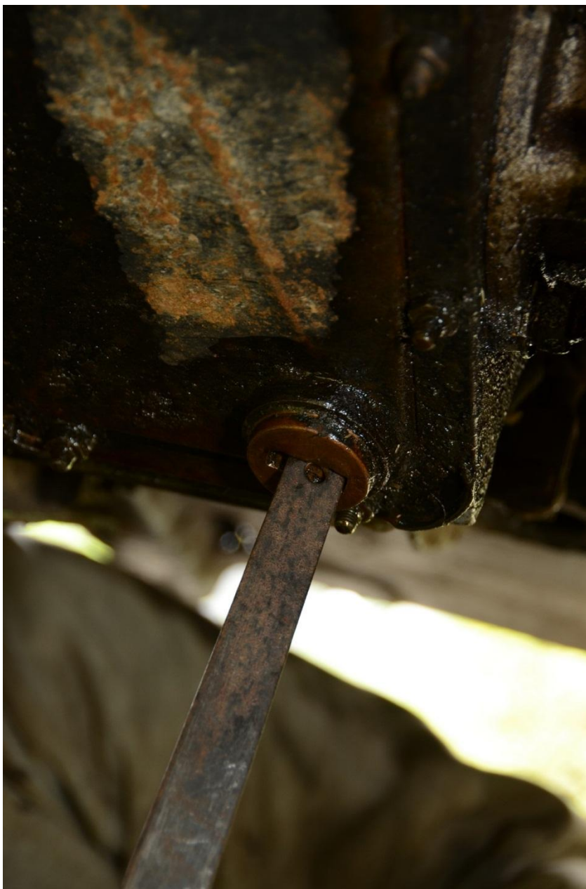
Billede 43: Bund prop på gearkasse tages ud
