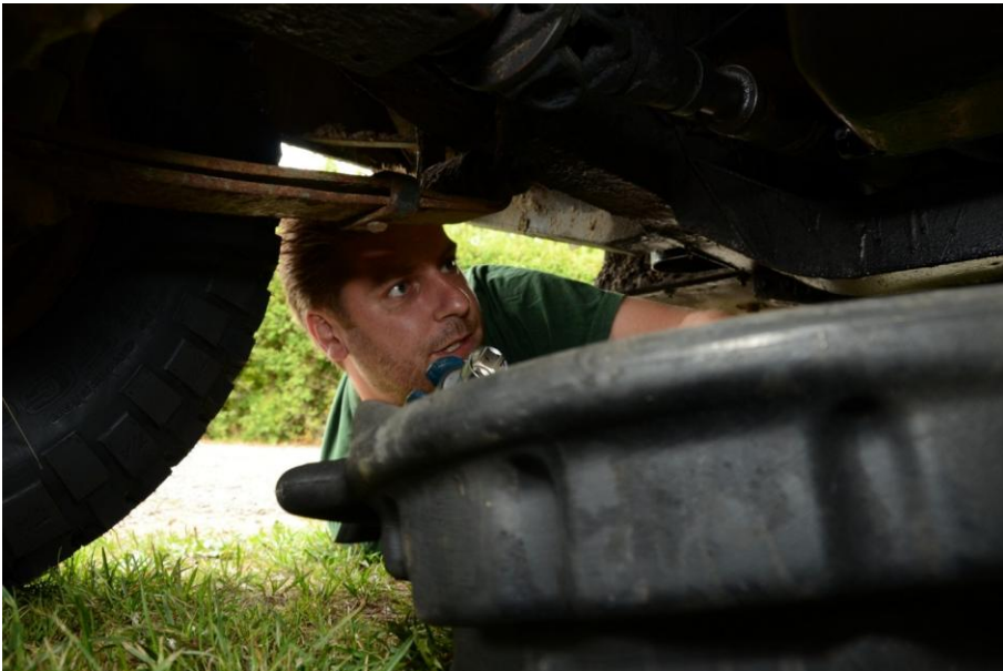
Billede 1: Bundproppen skal til at skrues
