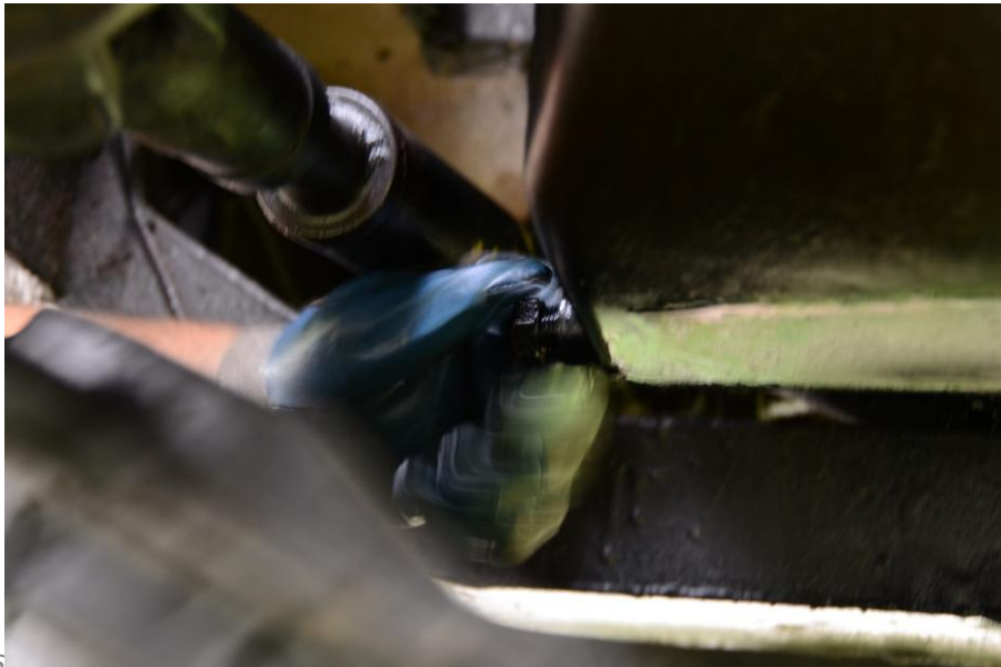
Billede 1: Bundproppen skal til at skrues
