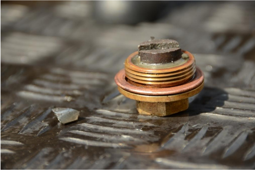
Billede 49: Bundprop med en tandhjuls tand, som fulgte med ud.
