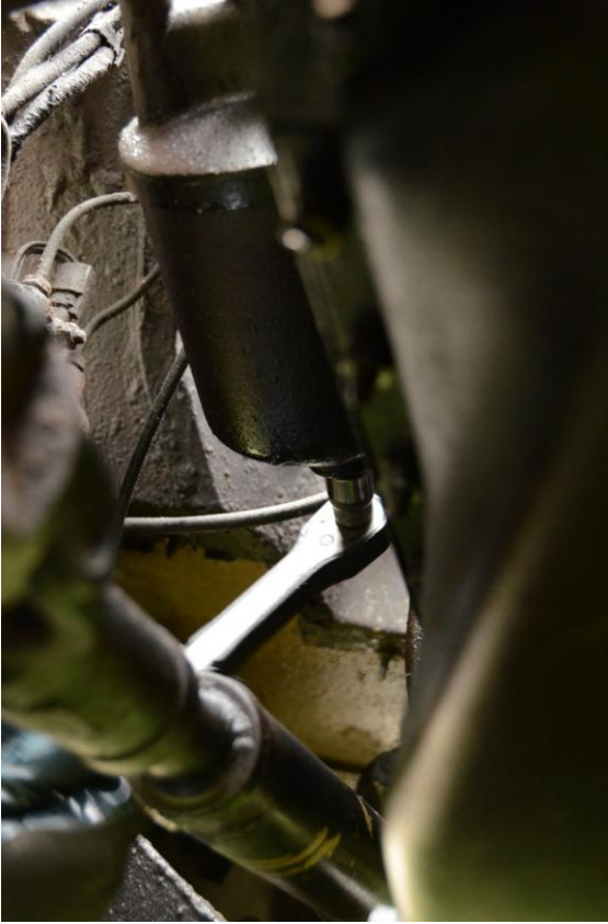
Billede 36: Oliefilter skrues af..
