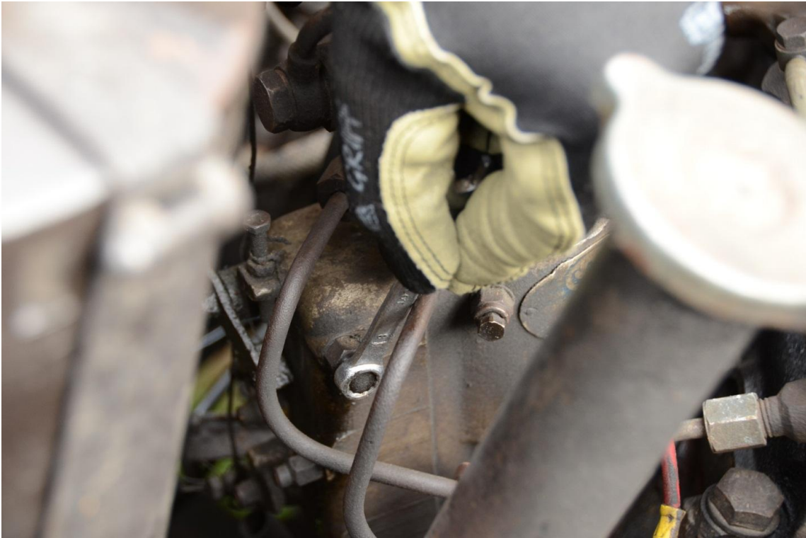
Billede 33: Bolt tæt på gas arm, løsnes..
