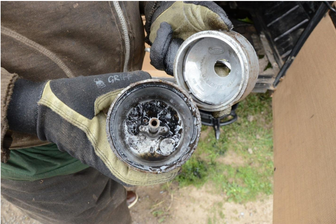
Billede 15: Vand/slam udskiller i to dele, bund til venstre, mellemstykke til højre.
