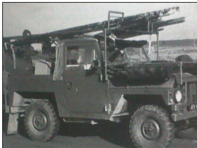
Fig.15: Kabellægger fra den engelske hær.
