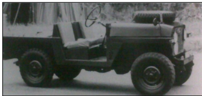
Fig.3: LW adskilt for lufttransport (Foto fra det engelske forsvar)
